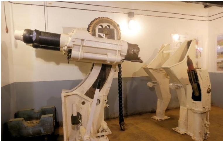
7,5 cm Haubitze, rechts vorne eine Granate in der Zuführung, dahinter die Abwürfe für die GeschöÙhülsen Unten: Elektrifizierte Schmalspur- Materialbahn
