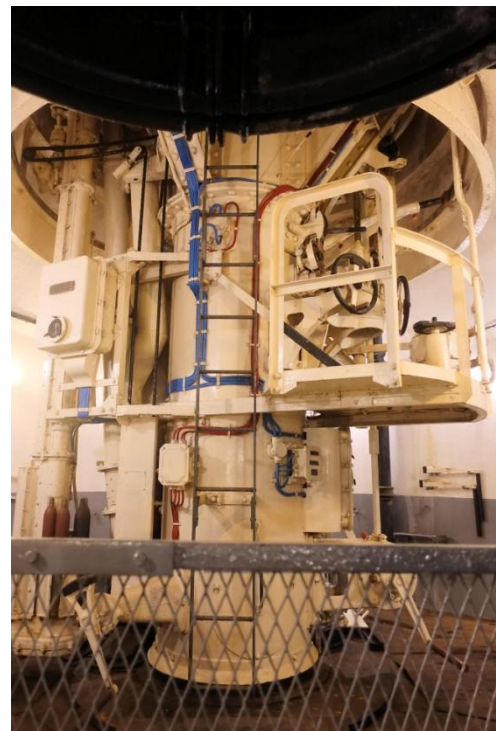
Der 30 Tonnen schwere Gefechtsstand konnte durch geschickte Ausbalancierung und durch einfache Hebel schnell durch einen einzigen Mann um 80 cm in Schussbereitschaft gehoben und wieder abgesenkt werden.
